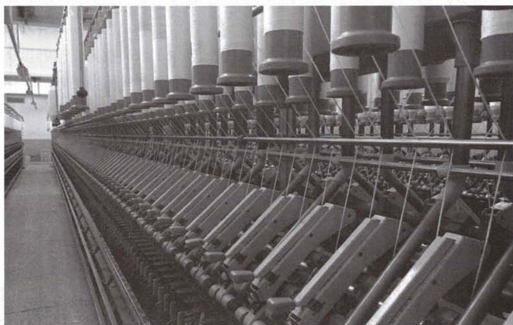
图 2 捻系数调整后换批的粗纱正常退绕运转，无空锭
